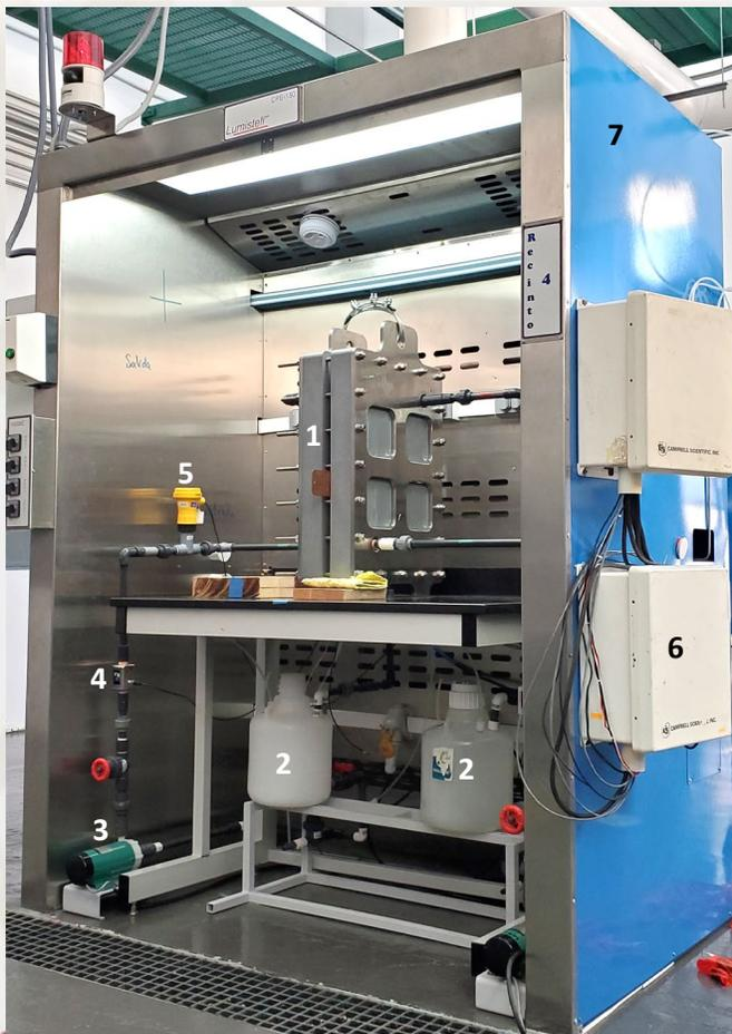
Estación de pruebas de baterías de flujo
